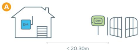
A) 1Control-SOLO platziert in der Nähe des Tores und 1Control-Link platziert im Haus, am Fenster, das dem Tor am nächsten liegt. Diese Lösung ermöglicht Ihnen, das Tor sowohl mit Bluetooth als auch mit WLAN zu öffnen.
