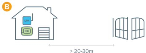
B) 1Control-SOLO und 1Control-LINK beide im Haus, an dem Fenster, das dem Tor am nächsten liegt, platziert. Auf diese Weise können Sie, indem Sie die Reichweite der auf Ihrem SOLO integrierten Fernbedienung nutzen, eine größere Entfernung abdecken und Ihr Tor über die WLAN-Verbindung öffnen.
