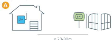
A) 1Control SOLO positionné près du portail et 1Control LINK positionné dans la maison sur la fenêtre la plus proche du portail. Avec ce positionnement, vous pouvez ouvrir la porte à la fois en utilisant le Bluetooth et en utilisant le Wi-Fi.
