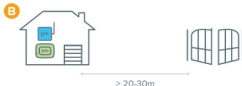
B) 1Control SOLO et 1Control LINK tous deux positionnés dans la maison sur la fenêtre la plus proche du portail. De cette façon, en profitant de la plage de fonctionnement de la télécommande copiée sur votre SOLO, il est possible de couvrir une plus grande distance et d'ouvrir en Wi-Fi.
